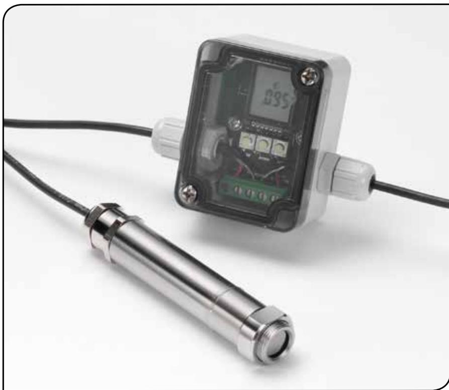
Les détecteurs infra-rouge sans contact PyroEpsilon mesurent des températures entre -20°C et 500°C, et fournissent une sortie linéaire de 4 jusqu'à 20mA. Ce signal de sortie est compatible avec pratiquement tous les indicateurs, régulateurs, enregistreurs, enregistreurs de données, etc., et n'exige aucune interface spécifique ni prétraitement de signal spécial.
