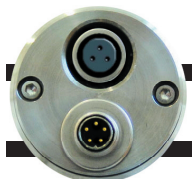
FL - Si/ GAi mit Geräte-Schnittstelle zum Anschluss von HP 04 oder AT - 301 USB und 5-poligem Stecker.
